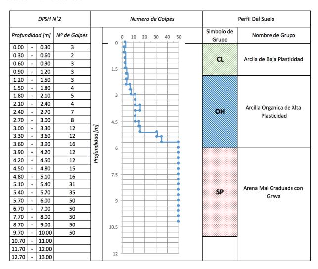
Los resultados de los ensayos de penetración se muestran a continuación:
